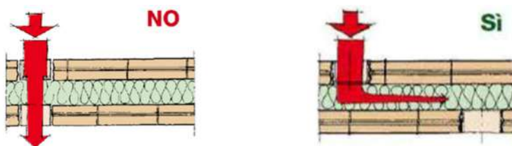
Fig. 10: Posizionamento scatole elettriche
