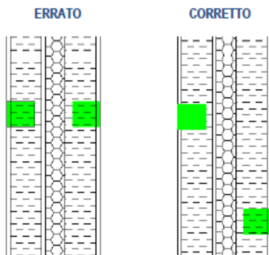
Fig. 3: Visualizzazione del corretto posizionamento delle scatolette e delle tracce
